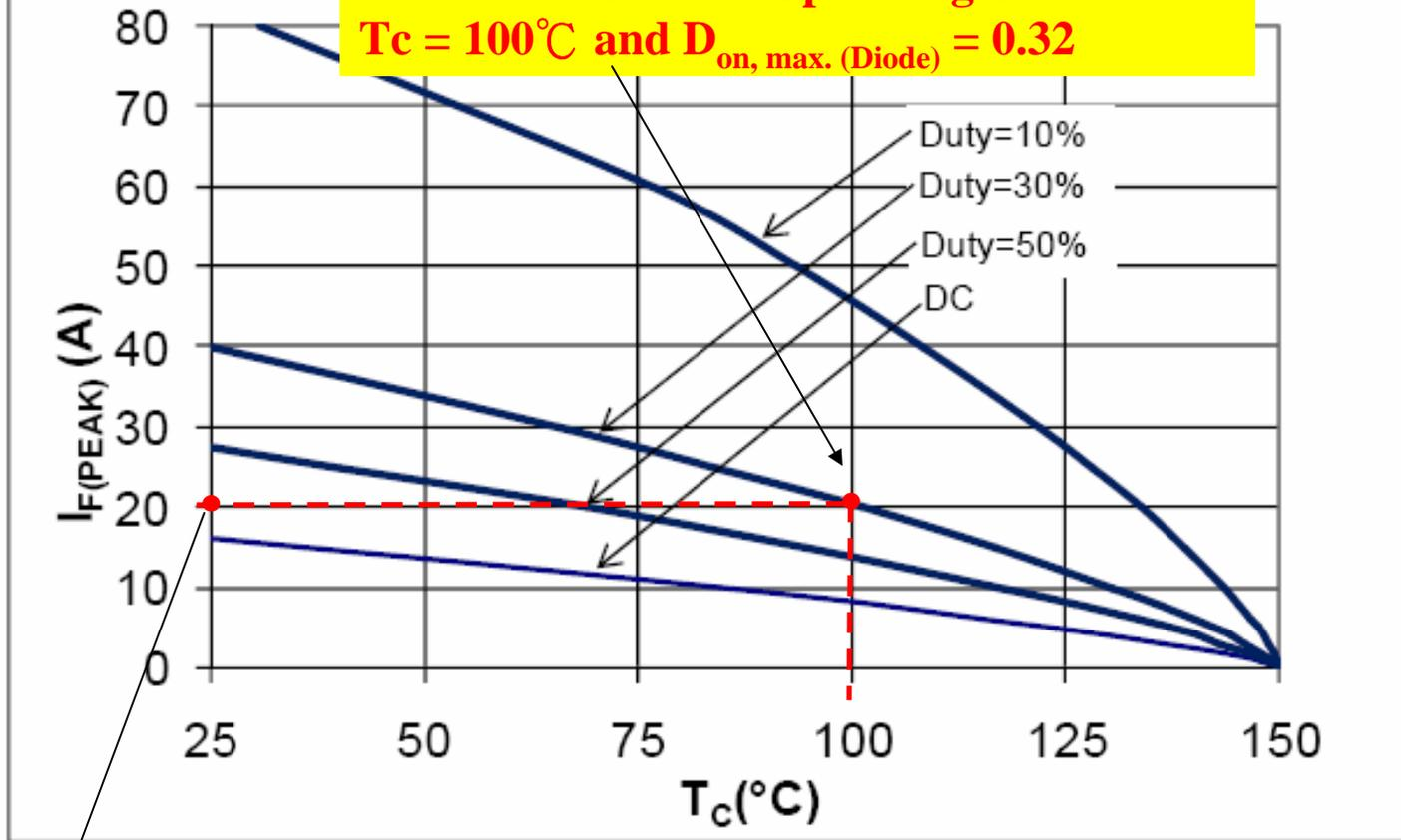
LQA08TC600  $I_{F(\text{PEAK})}$  vs  $T_c$ ,  $f=70\text{kHz}$ .
